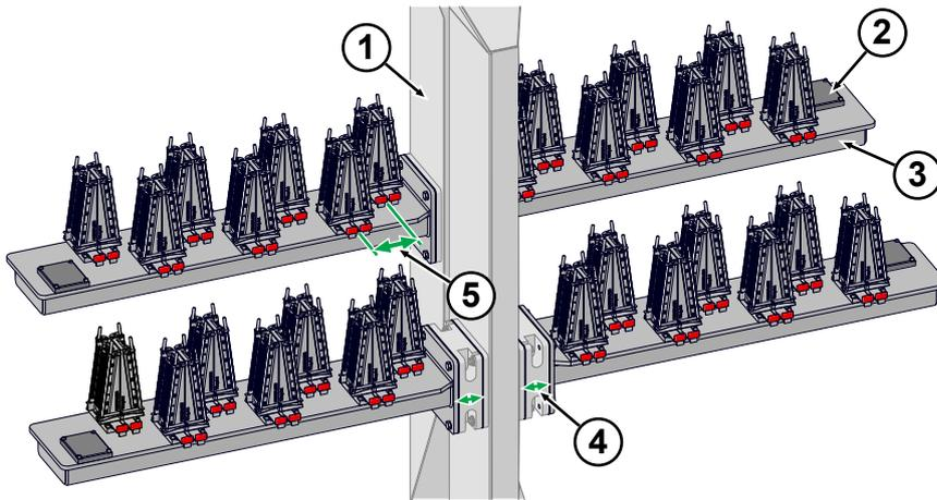
图2 例如: 28 x WarpJet-KV, 带 1792 股纱线支撑架
